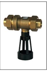
Destiné à la protection des réseaux d'eau potable contre les retours de fluides jusqu'à la catégorie 3 de risque suivant la norme NF EN1717. Le dispositif est prévu pour empêcher tout retour d'eau polluée par contre pression ou siphonage dans le réseau de distribution d'eau potable.
