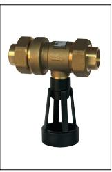
Progettato per proteggere le reti d'acqua potabile dai fluidi pericolosi (classificati fino alla categoria 3 secondo la norma NF EN1717), il disconnettore CA 2096 impedisce il reflusso dell'acqua contaminata nella rete di distribuzione di acqua potabile per contropressione o sifonaggio.
