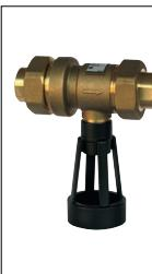
Ontworpen voor de bescherming van drinkwaternetwerken tegen terugstroming van vloeistoffen tot risicocategorie 3 volgens de norm NF EN1717. Het systeem is ontworpen om terugstroming van verontreinigd water door tegendruk of overheveling naar het drinkwaternet te voorkomen.
