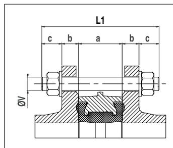
**Per corpo ad anello; assemblaggio con tiranti:**
