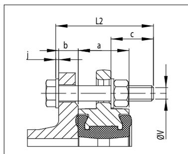
**Per corpo con flangia centrale (smontaggio a valle permanente); assemblaggio con bulloni:**
