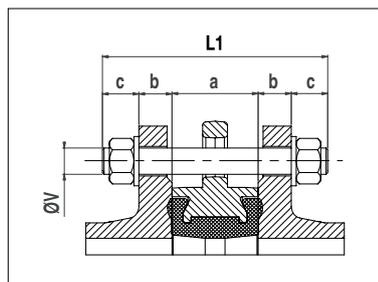
**Per corpo con orecchie di centraggio e flangia centrale; assemblaggio con tiranti:**
