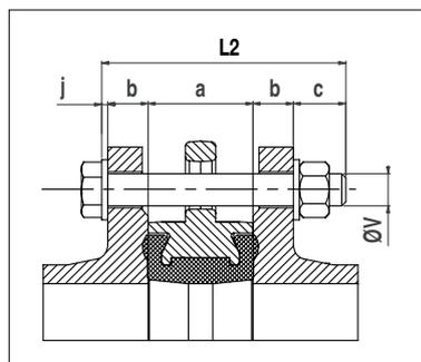
**Per corpo con orecchie di centraggio e flangia centrale; assemblaggio con bulloni:**
