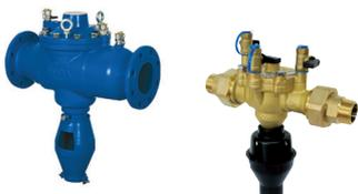
Les disconnecteurs à zones de pression réduites contrôlables de type BA protègent les réseaux d'eau potable contre un risque de pollution retour d'eau en interrompant l'alimentation d'eau par auto-vidange et mise à l'égout du fluide de risque jusqu'à catégorie 4.
