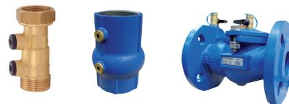
Les clapets antipollution contrôlables de type EA protègent les réseaux d'eau potable contre des retours de fluides ne présentant pas de risque toxique ou microbiologique pour la santé humaine (cat.1 et/ou 2). A l'installation, leur pose doit obligatoirement associer en leur amont immédiat, d'un dispositif d'isolement (robinet arrêt) ainsi qu'un dispositif de contrôle (robinet d'essais) placé sur un bossage amont.
