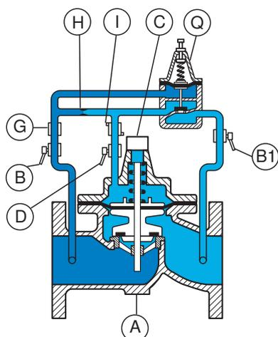
Tant que la pression amont est inférieure à la pression de consigne, le pilote (Q) est fermé, la pression amont reste appliquée sur la membrane de la vanne principale (A) qui reste fermée.
