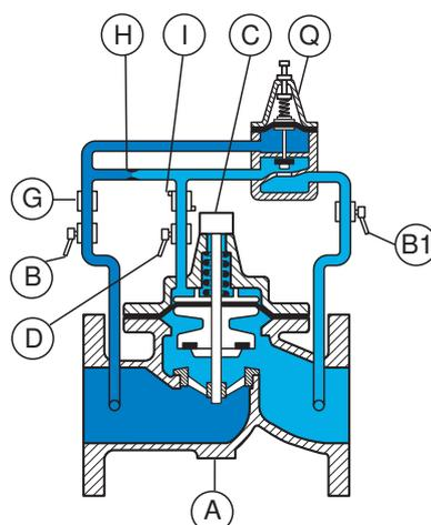
Dès que la pression amont s'élève au-dessus de la pression de consigne, le pilote (Q) s'ouvre, évacue la pression s'appliquant sur le membrane de la vanne principale (A). Celle-ci s'ouvre, la surpression s'évacue.
