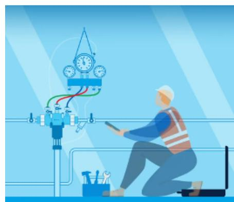
Le CSTB recommande également un contrôle annuel des disconnecteurs à zone de pression réduite contrôlable de type CAa ainsi que des clapets antipollution de type EA à brides. Des fiches de maintenance sont disponibles sur le site du CSTB ainsi que sur Digisco.fr.
