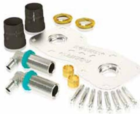
Le principe du ROBIFIX®+ est simple : il suffit de fixer la plaque-support en acier sur une cloison en plaque de plâtre ou alvéolaire et de positionner dessus les deux coudes avec leurs raccords spécifiques directement reliés aux tubes PER. Tout le système de fixation disparaît alors sous la couche de colle et sous le revêtement mural choisi pour devenir totalement invisible à l'œil nu.
